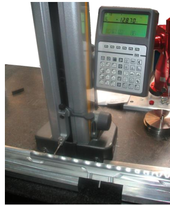
Messung der gefrästen 3D-Modulation an einer Probeelektrode aus Al
